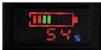
**Indikator napona** – u kabinu vozila se montira indikator napona, spojen na akumulator koji upozorava vozača na stanje napunjenošću akumulatora. Kada razina napunjenošću padne ispod 20%, akumulator je potrebno zamijeniti.
