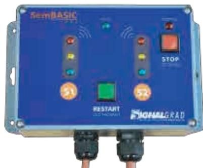
**S2 (slave)** - sekundarna upravljačka jedinica, sastoji se od tipke za pozivanje parametara, dodatne tipke za zatvaranje gradilišta (STOP funkcija) i 8 LED-ica za prikaz statusa, među kojima je i prikaz intervala na semaforima. Upravljačka jedinica je spojena na semafor SiHF kabelom otpornim na visoke temperature i SP21 konektorom.
