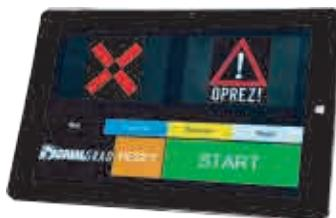
**Windows OS** – upravljačka jedinica je tablet sa Windows OS-om. Uređaj u sebi sadrži spremljene programe koje šalje žičano na uređaj. Na uređaju se nalazi osnovni program s minimumom funkcija koje osiguravaju funkcionalnost uređaja. Tablet se montira u kabinu vozila.
