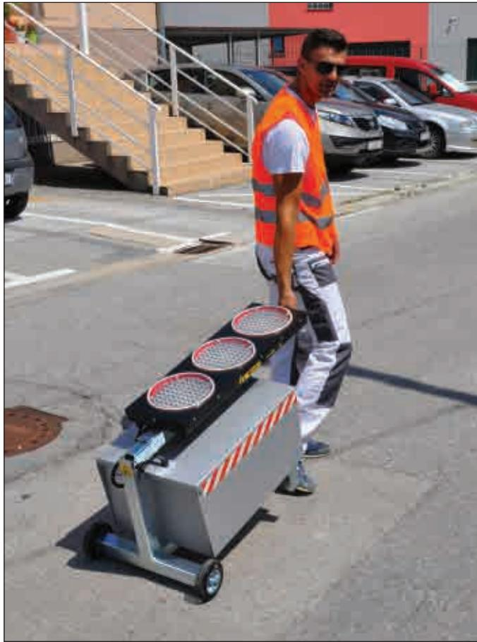
**Mehaničko sklapanje i zaključavanje** – klizni sustav zaključavanja lanterne omogućuje lakši transport semafora sa drugu lokaciju.
